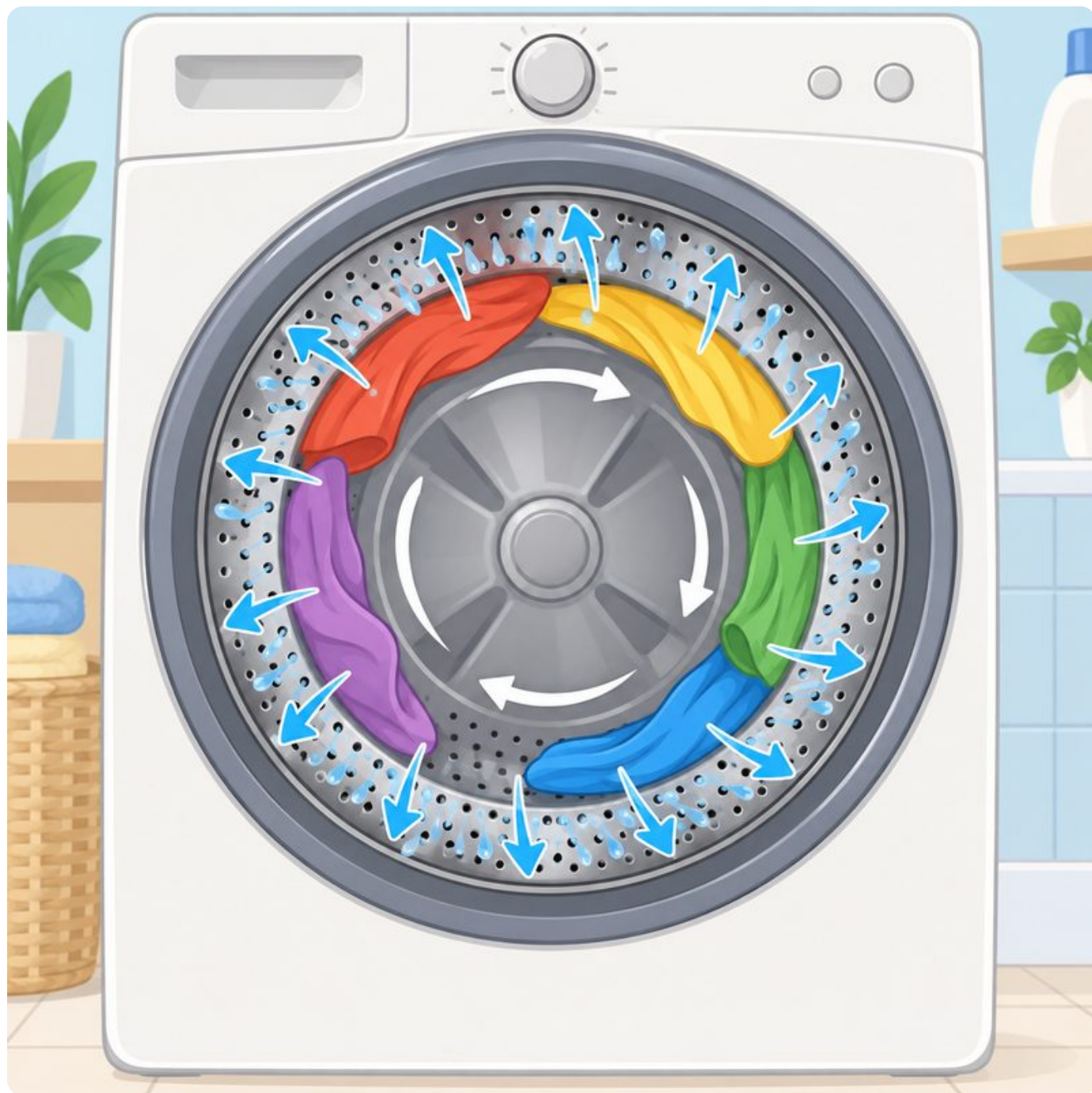
▲ 高速旋转中，水从小孔飞出，衣服贴在桶壁上
